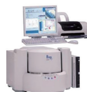
荧光X仪——原材测定 胶带的ROHS六项测定
