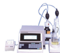
水分仪——胶粘剂用 原材料的水分的测定
