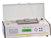
摩擦系数仪—— 静、动摩擦系数测定
