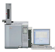
气象色谱仪 残留溶剂含量测定
